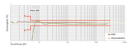
Der Vergleich der metrologischen Messfehlerkurve des iPERL mit einem herkömmlichen Ultraschallzähler (grün) veranschaulicht die deutlichen Vorteile. Aufgrund seiner herausragenden messtechnischen Leistung gewährleistet iPERL die zuverlässige Messung der vom Wasserwerk an den Verbraucher gelieferten Wassermengen und trägt damit zur deutlichen Reduzierung von Wasserverlusten bei.
