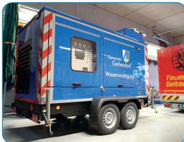
Das im Herbst neu beschaffte mobile Notstromaggregat der Gemeinde Geltendorf kann im Falle eines Blackouts die beiden Wasserbrunnen in Walleshausen (die die gesamte Gemeinde versorgen) und die Wasseraufbereitung am Laufen halten. Ein ortsfestes Notstromaggregat im Wasserhochbehälter in Petzenhofen sorgt für eine zuverlässige Verteilung des Geltendorfer Trinkwassers auch in die Hochzonen unserer Gemeinde, für die kein ausreichender Gefälledruck gegeben ist.
