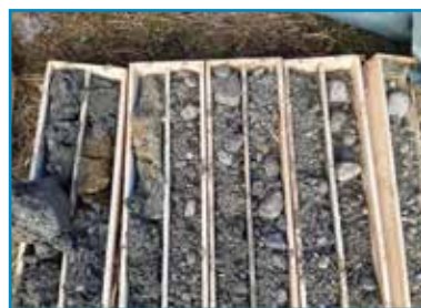
Während des Bohrvorgangs wurden meterweise Bodenproben genommen, die einen interessanten Einblick geben in die verschiedenen geologischen Schichten am Bohrtort.
