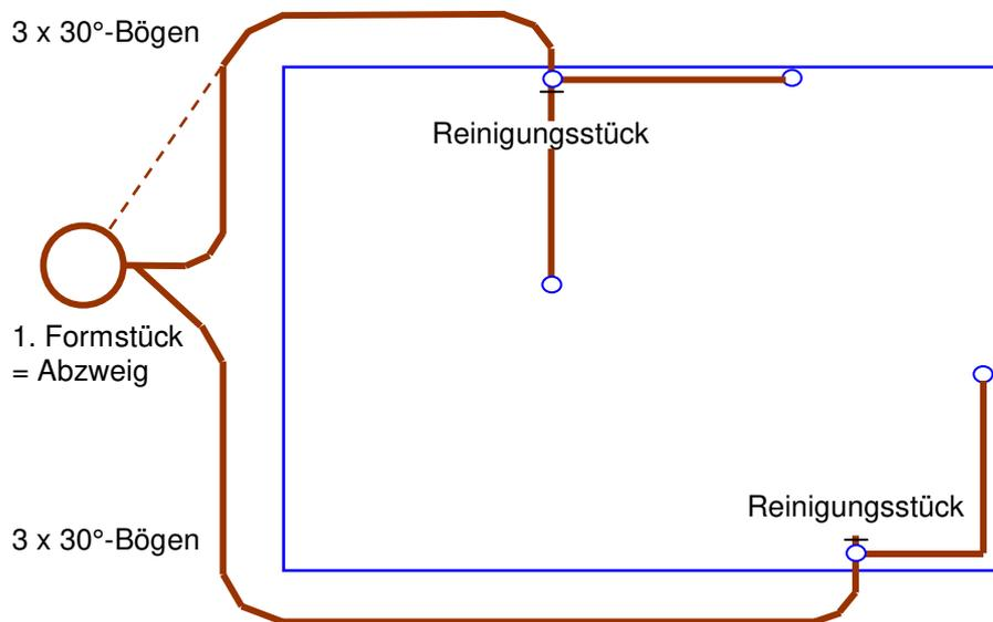
Bei Zuläufen aus verschiedenen Richtungen zum Revisionsschacht:
