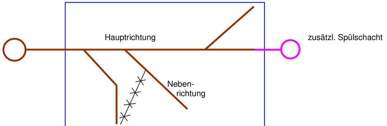
Nach Möglichkeit keine Bodenabläufe im Keller einbauen, sofern keine höherwertige Nutzung des Kellergeschosses vorgesehen ist. Stattdessen die Abwasserrohre unter der Kellerdecke zusammenführen und durch die Kellerwand nach außen führen und die Außenleitungen im Arbeitsraum der Gebäude-Baugrube verlegen.
