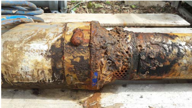
Verockerte Brunnenpumpe aus dem Brunnen I, daher schlechte Durchflussleistung (nicht gesundheitsschädlich)
