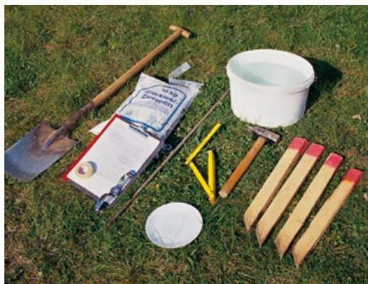
Abb.: Benötigte Materialien und Werkzeuge für die Durchführung des Versickerungsversuches.
