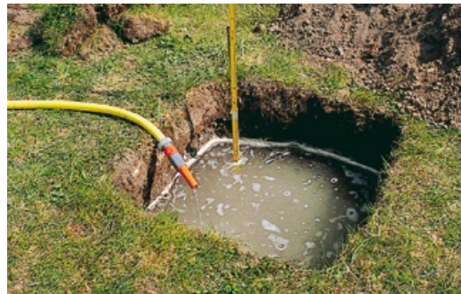
Abb. links unten: Vorbewässerung der Grube und Anbringen eines Meterstabes.
