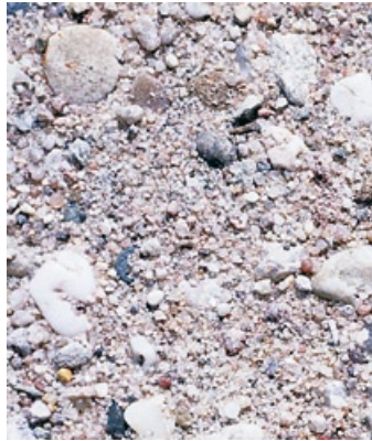
Abb. mitte: Feinsand – mittlere Wasserdurchlässigkeit.
